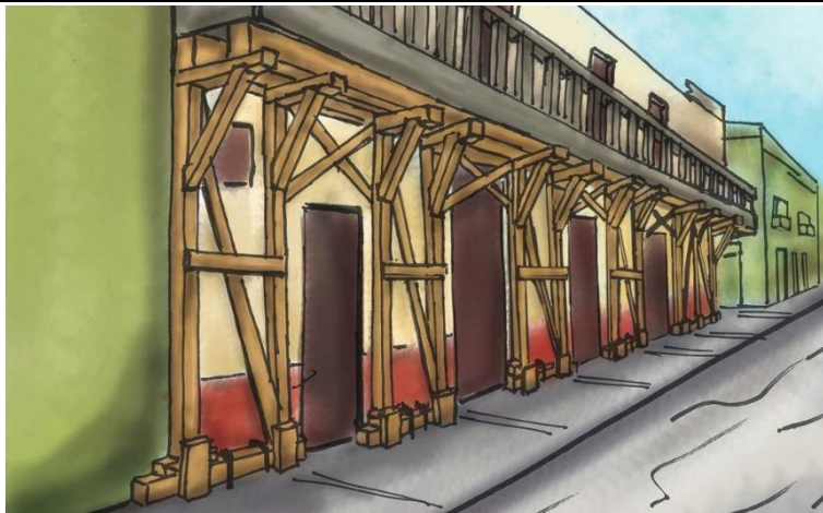
IMAGEN 12. EJEMPLO DE APAUNTAMIENTO DE DINTEL
